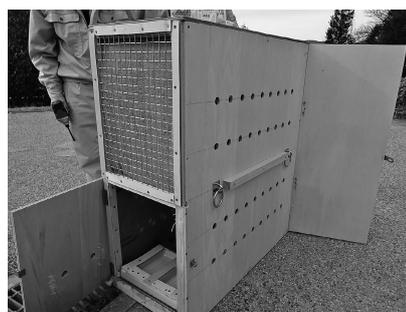
図2. コウノトリを欧州に輸出するためIATAの基準に合わせて作製された輸送箱。
