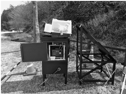
図2. 兵庫県豊岡市祥雲寺地区の人工巣塔を撮影するために現地に設置された機材。左側の木箱の上部にあるケースにウェブカメラと単眼鏡を格納し、木箱の中にモバイルWi-Fiルータ、モバイルバッテリー（電圧5V）、ポータブル電源（電圧12V）を格納した。右側にあるのはソーラーパネルを固定した木製架台である。ケースや木箱は南京錠で施錠し、強風等による損傷を避けるため木箱と架台を金属製の杭と針金で地面に固定した。
